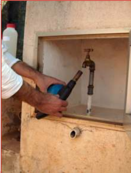
Desinfeção de ponto de colheita de água para análise
