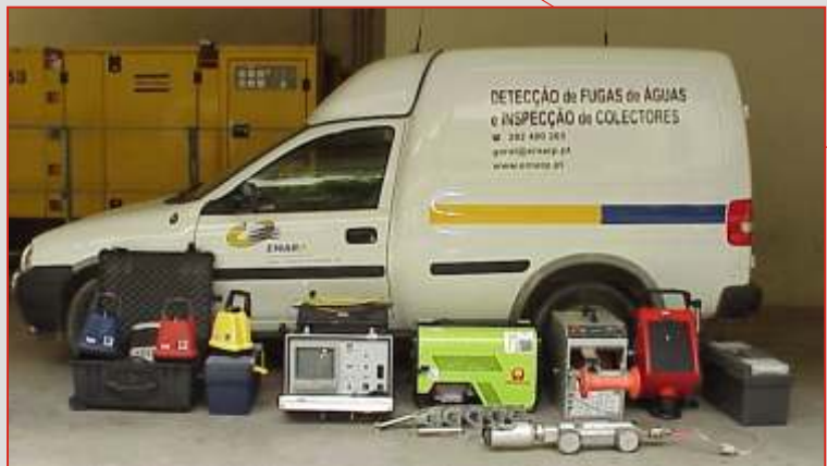
Veículo de Detecção de Fugas de Água e Inspeção de Colectores
